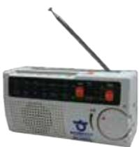
地震や津波などの緊急情報や災害情報をお知らせするラジオです。緊急時には自動で起動し、情報が流れます。平常時は、一般のAM・FMラジオ放送を聴くことができます。
