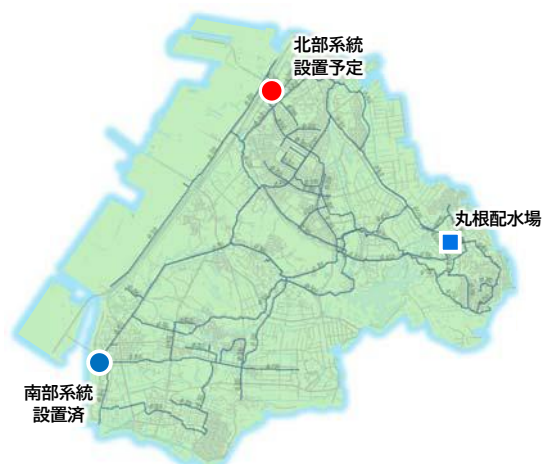
自動水質監視装置設置箇所マップ
