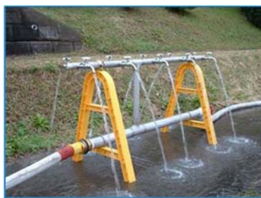
仮設給水スタンドによる 水道水の供給風景
