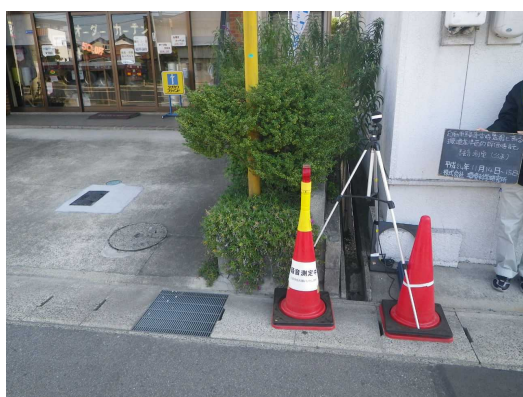
道路交通騒音測定
