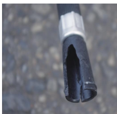
× ノズルの破損
