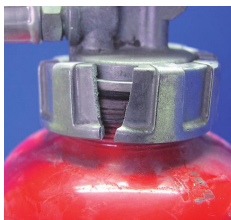
× キャップの破損
