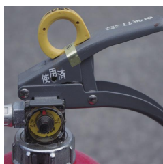
× 表示装置の脱落
