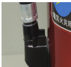
× 消火薬剤の漏れ
